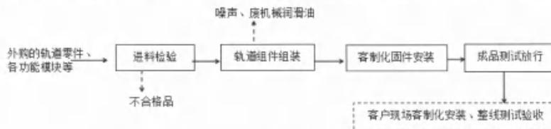
**图 2-2 项目全自动样品处理系统生产工艺及产污点图**
