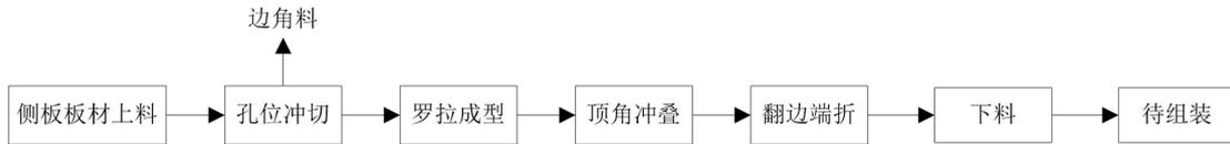
图 2-1 环评报告钣金生产工艺流程图
