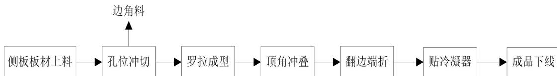
图 2-2 钣金工序实际生产工艺流程图
