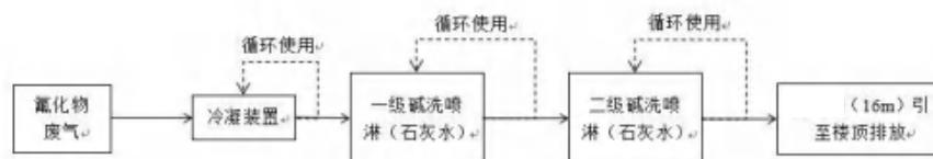
图 3-4 项目环评中高温纯化炉尾气处理工艺流程图
