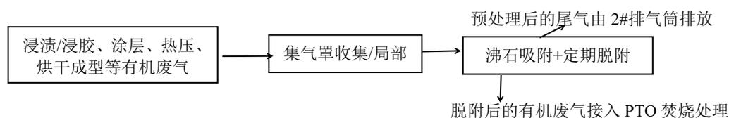
图 3-2 项目环评中有机废气预处理工艺流程图
